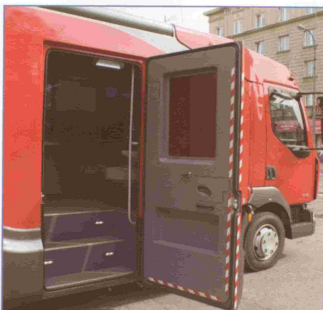
Wejście do przedziału załogowo – analitycznego. Przyciemniane szyby, ciemna kolorystyka wnętrza oraz specjalne oświetlenie pozwalają na wygodną pracę na sprzęcie elektronicznym.
